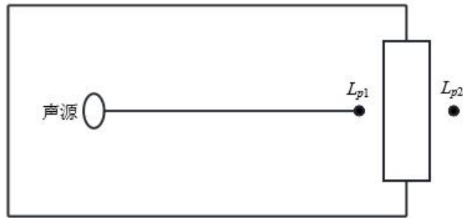
图 4-1 室内声源等效为室外声源图例
